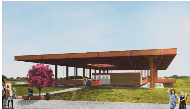
2. ábra. Romokat védő tervezett acélszerkezet
