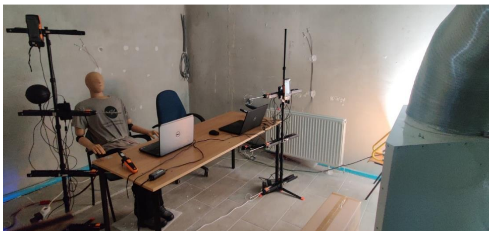
1. ábra. A mérőkammera berendezése. Bal oldalon a mérőbábú és annak a környezetét mérő TESTO állvány. Mellette az élő alany helye és munkahelye, valamint a környezetét mérő TESTO állvány. A kép jobb oldalán a befűvő doboza látható.
