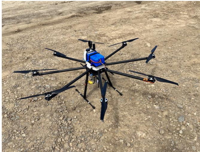
2. ábra. LiDAR szkennerttel felszerelt drón
