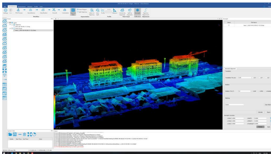
11. ábra. 3D-s homlokzatok és területek szkennelése
