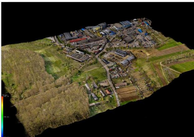
7. ábra. 3D szkennelés– színesített pontfelhő
