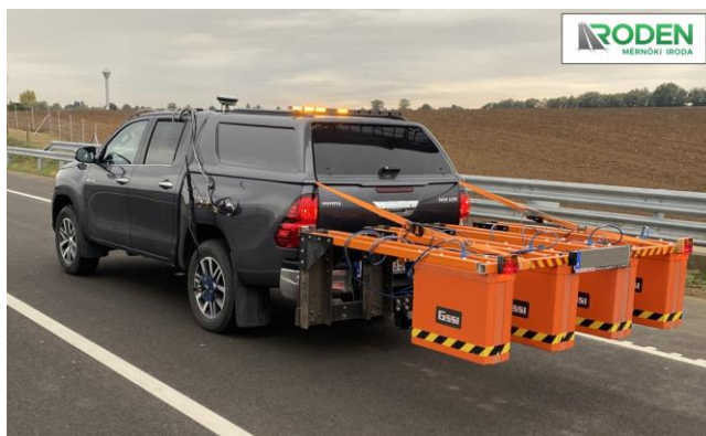
1. ábra. A felmérés sematikus ábrája (balra) és a RODEN Mérnöki Iroda Kft. RoadScan mérőautója (jobbra)
