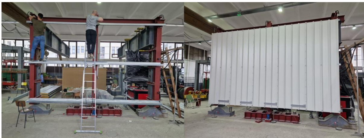
2. ábra. A kísérleti szerkezet váza (balra) és a kísérletre előkészített tetőtárcsa (jobbra)
