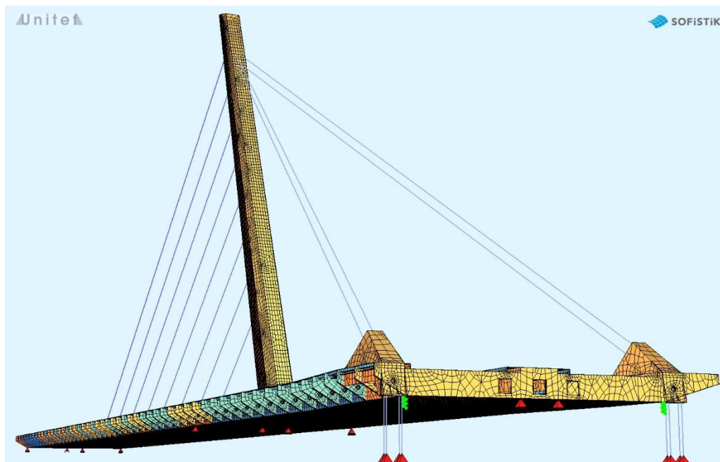
2. ábra. Híd teljes numerikus modellje (SOFiSTiK VEM-modell)
