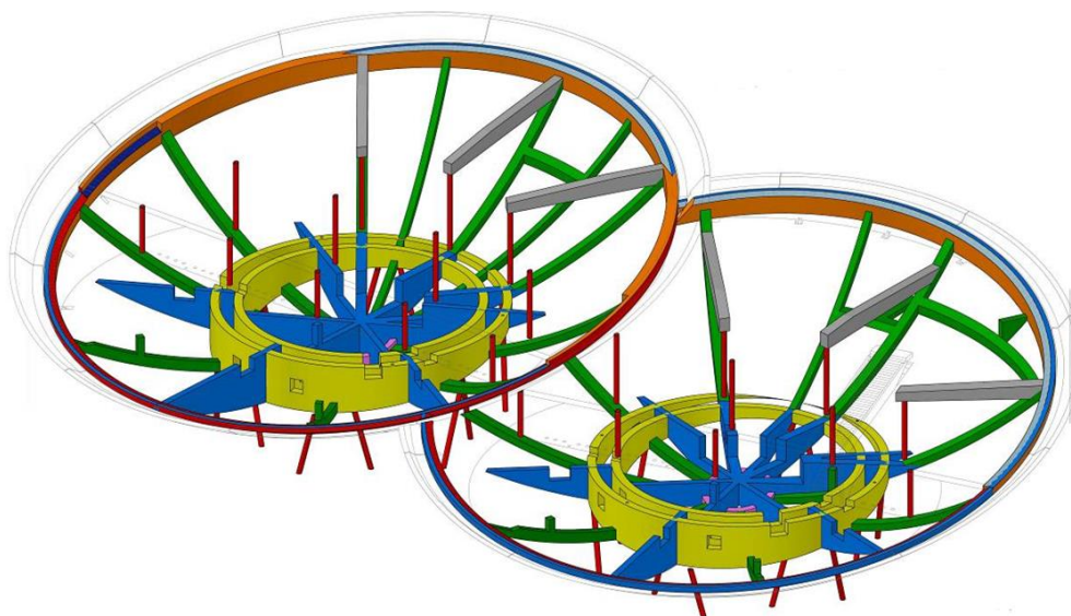
3. ábra. A tálszerkezet fő teherviselő vasbeton váza
