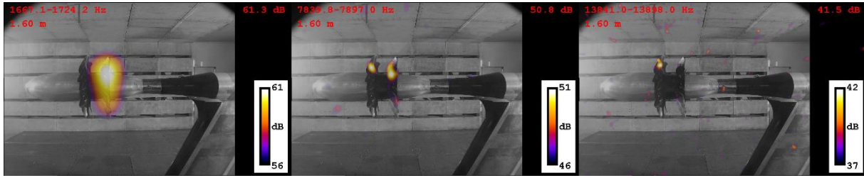
3. ábra Eredeti frekvenciasáv háromszorosának alkalmazásából kapott néhány zajtérkép
